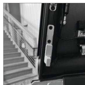
Zadní posuvný západkový mechanismus v odemčené poloze. Fotografie západkového mechanismu na straně řidiče.
