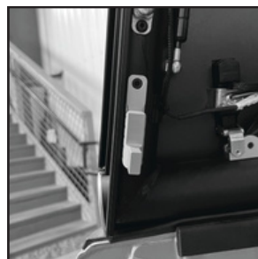
Zadní posuvný západkový mechanismus v zajištěné poloze. Fotografie západkového mechanismu na straně řidiče.
